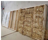
Contrôle en chambre climatique durant 3 phases représentatives de conditions climatiques extérieures.
